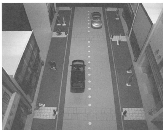
写真2 山王通りみち広場街路のイメージ 模型…車道を半たわみ舗装で石畳風にするのは、一部のみ実現した
