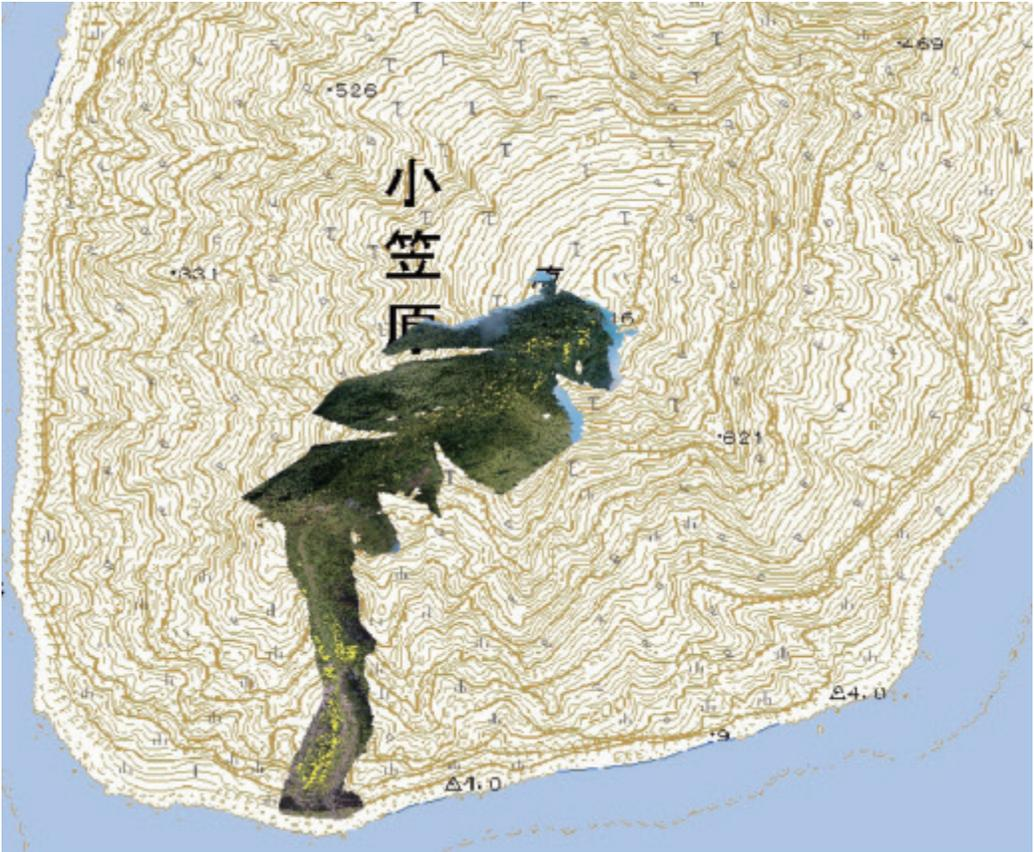
図3. 2枚のオルソ画像（図2）を幾何補正して、地理院地図上に重ね合わせた図
