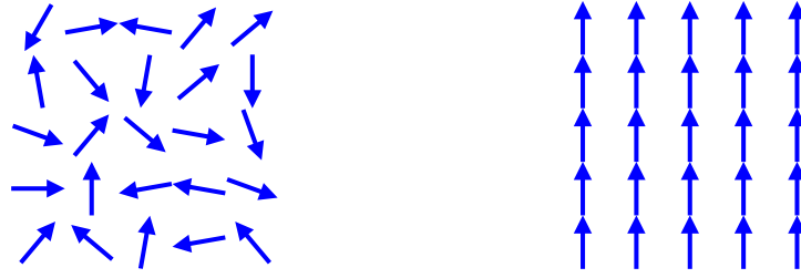
図 43: スピン系の状態の模式図。左：高温でスピンの向きがランダム（回転対称性あり）。右：低温でスピンの向きが揃う（回転対称性がない）
