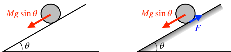
図 17: 斜面上の剛体にはたらく x 軸方向の力。左：摩擦なし、右：摩擦あり
