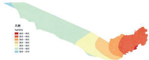
図-2 クリギング法による気温分布 例：7月21日13時
