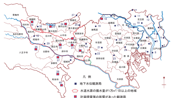
図-1 地下水位観測局の配置状況
