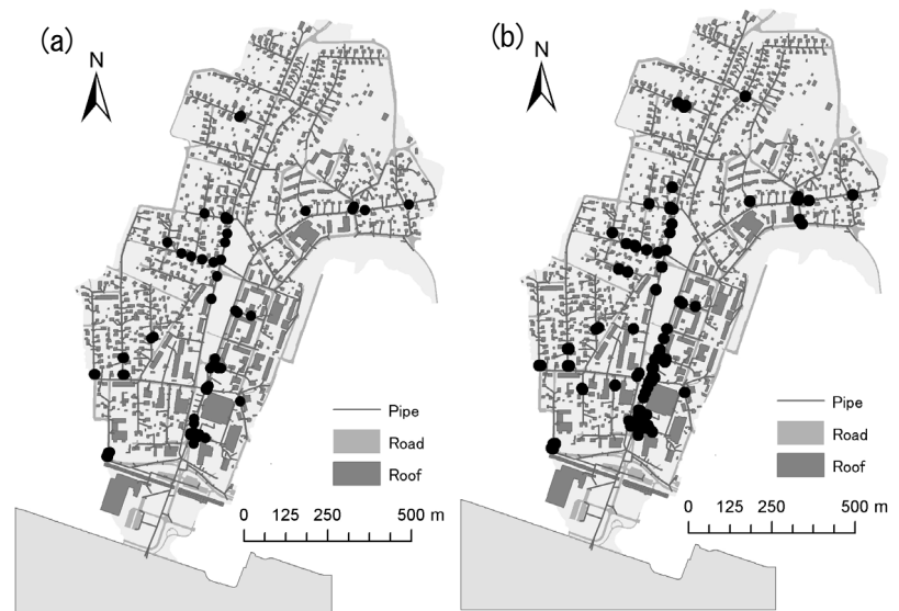
図-5 溢水マンホール (a)TC, (b)F3
