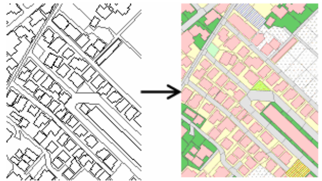
(a) 基礎的地物データ GIS (b) 高度な地物データ GIS
