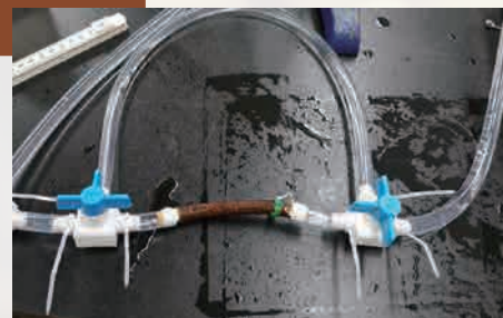
枝内部の水の通りやすさを測っているところ ▲
