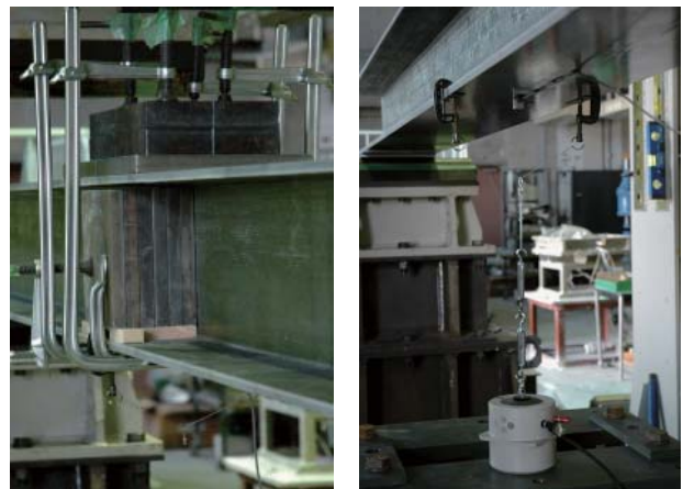
写真-1 質量付加の状況 写真-2 加振器の設置状況
