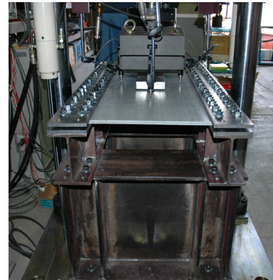
図-14 押し抜き試験のセットアップ状況
