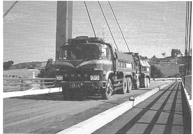
写真-5 載荷試験状況
