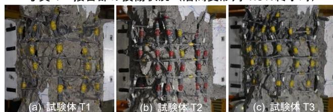
写真2 接合部の最終破壊状況
