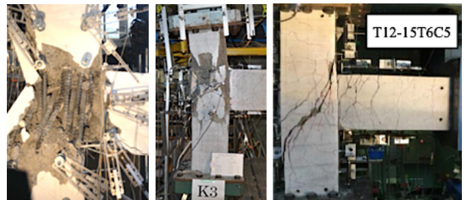
写真1 既往実験における接合部軸崩壊の様子
