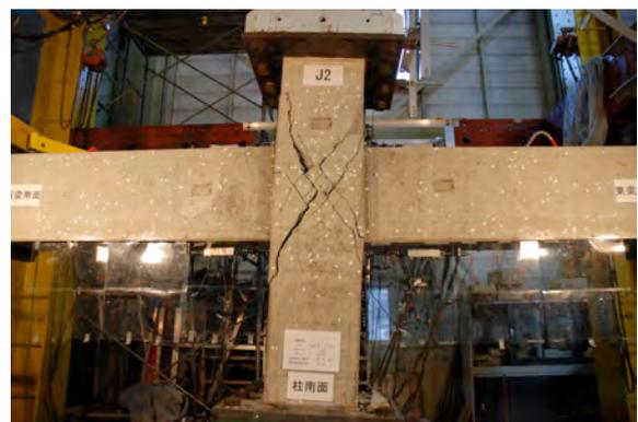
写真3 柱梁接合部の曲げ降伏破壊（柱梁曲げ耐力比1.4、首都大学東京<sup>24)</sup>）
