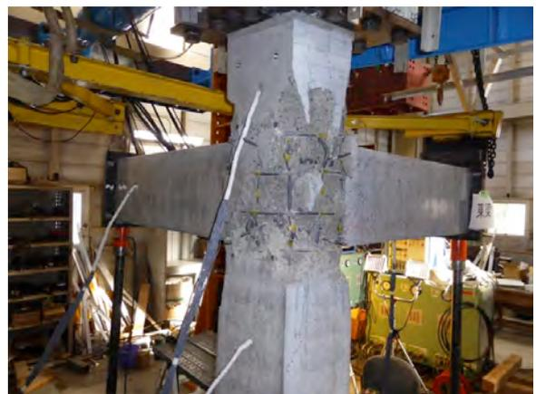
写真4 立体隅柱梁接合部の曲げ降伏破壊(首都大学東京<sup>39)</sup>)
