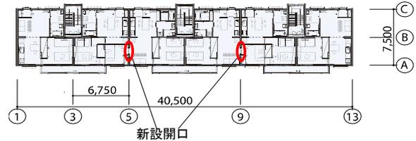
図1 検討対象建物の平面図と新設開口位置
