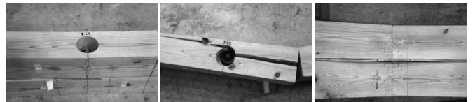
(b) 木材曲げ破壊 (c) 木材割裂破壊 (d) 圧縮側鋼板の座屈
