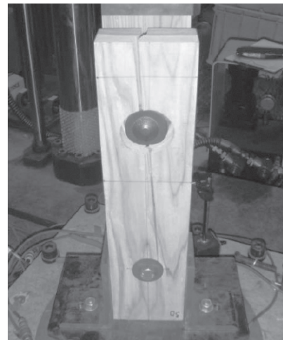
図13 破壊の割裂状況
