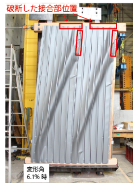
図8 試験体変形状況 (R=6.1%時)
