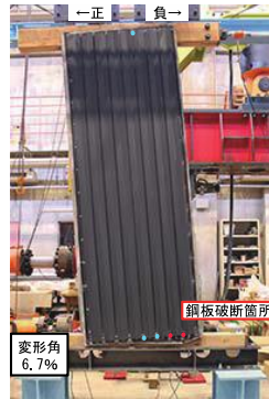
図7 試験体Fの変形の様子 ( \gamma=6.7\% )
