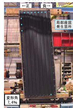
図 5 試験体 E の変形の様子 ( \gamma=7.4\% )
