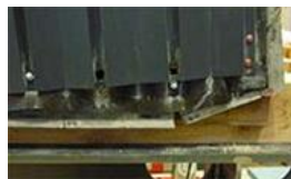
図8 試験体Fの鋼板の損傷
