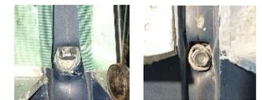
写真1 ビス近傍の損傷(載荷終了後)
